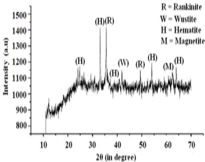
Fig. 5. XRD of SMS slag
